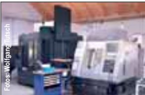
Fotos: Wolfgang Hiltisch Für die Präzisionsfertigung kommen Hightech-Maschinen zum Einsatz. Links im Bild die neue Makino V33i.
