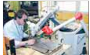
Mit dem mobilen Laserschweißen kommen die Experten von SR-Erodieretechnik direkt zum Kunden.
