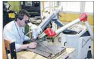
Mit dem mobilen Laserschweißen kommen die Experten von SR-Erodier-technik direkt zum Kunden.
