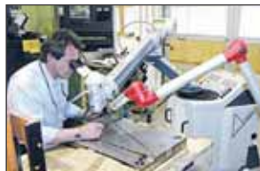
Mit dem mobilen Laserschweißen kommen die Experten von SR-Erodier-technik direkt zum Kunden.
